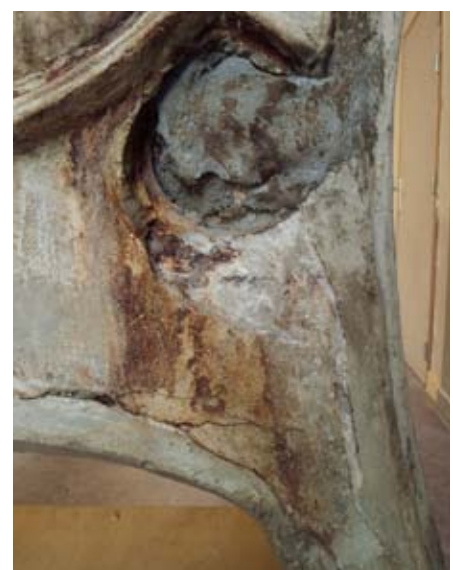
FIG. 257 Exsudat des produits de corrosion maculant le revers du dossier.
