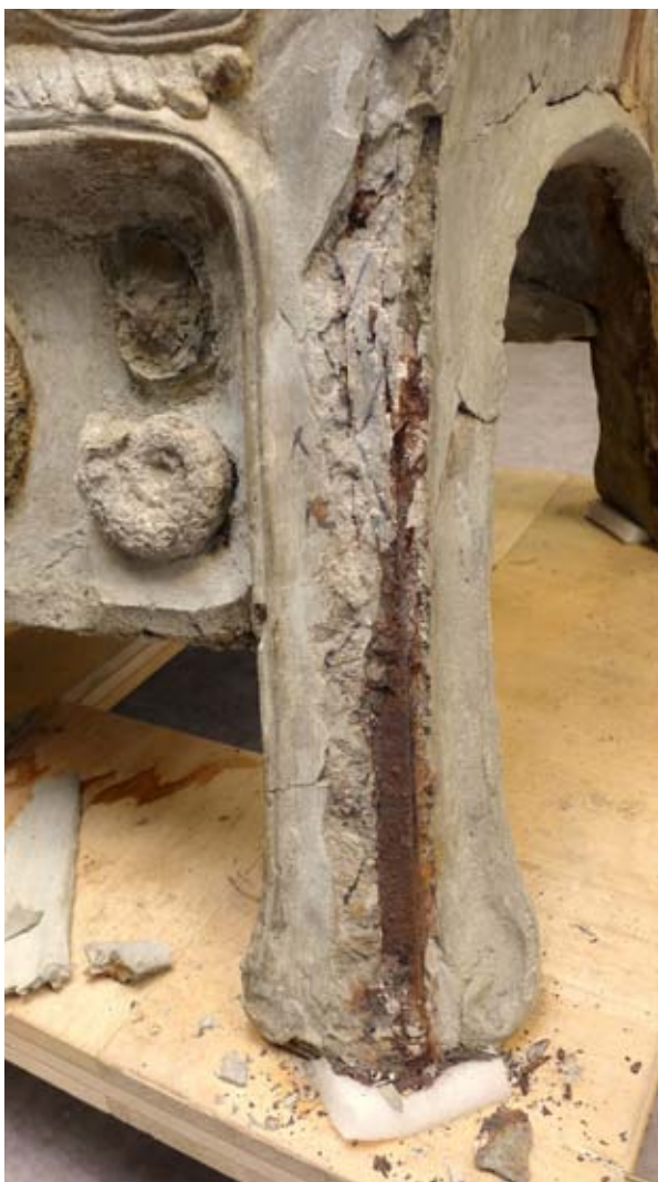
FIG. 348 Angle du pied arrière gauche après dépose des soulèvements
