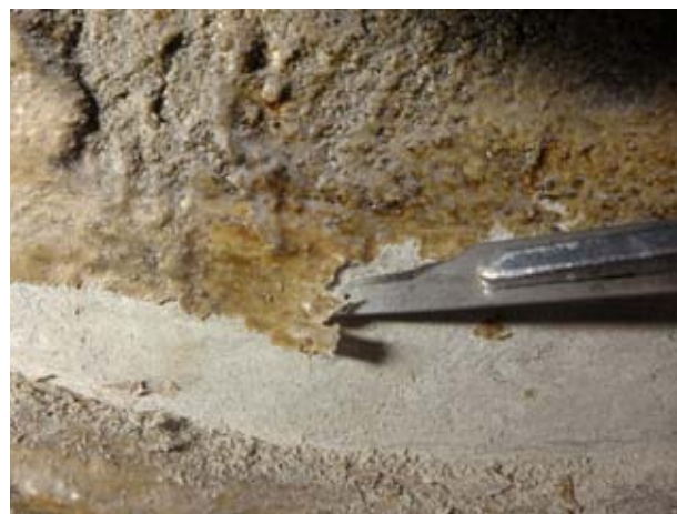
FIG. 322 Test n° 8 : Clivage au scalpel sur une surface plane. Résultat immédiat mais laborieux.
