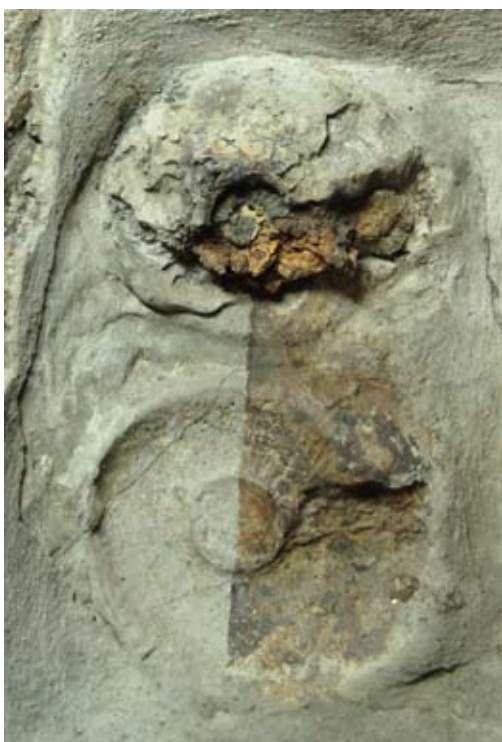
FIG. 371 Élimination de la coulure due à l'oxydation de la pyrite de G2 par projection de poudre d'alumine.
