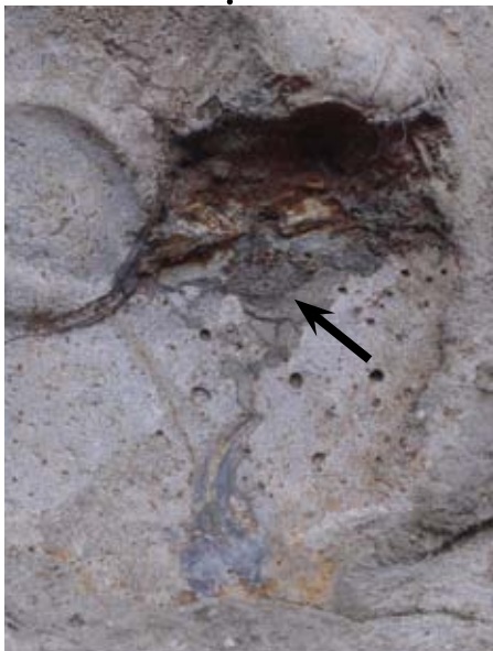
FIG. 280 Reliquats de coquille pyritisée à l'emplacement de G3, (après élimination de la coulure d'oxydes).
