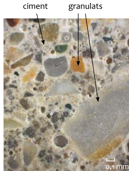
FIG. 225 Échantillon de mortier de ciment (coffrage), lame mince vue sous microscope optique (G x 10).
