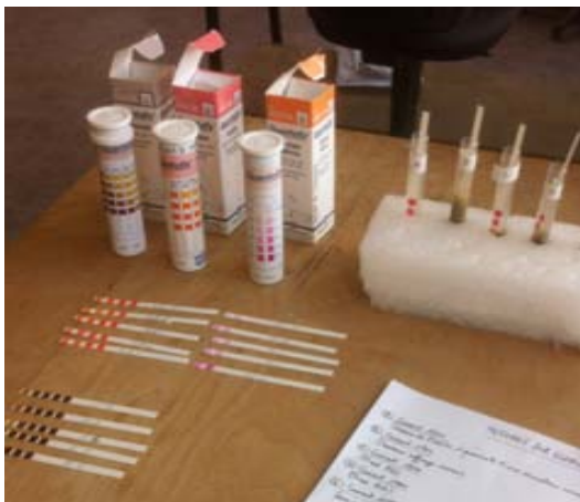
FIG. 244 Caractérisation des sels par bandelettes-test.
