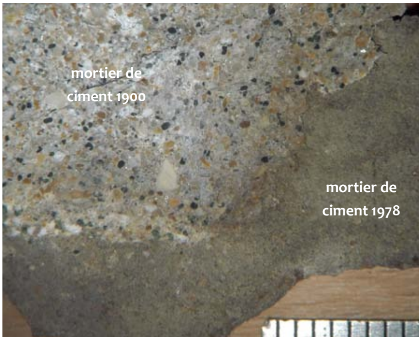
FIG. 230 Aspect des deux types de mortiers de ciment observés sur une épaufrure. Vue sous loupe binoculaire ( G \times 3 ).
