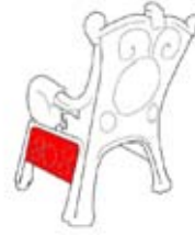
FIG. 137 Intérieur du panneau droit, délimitation des planches du coffrage original.
