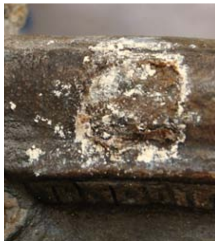
FIG. 320 Test n° 4 : Pâte absorbante acétone + attapulgite + carboxyméthylcellulose (5%). Action relativement efficace, nécessite un rinçage.
