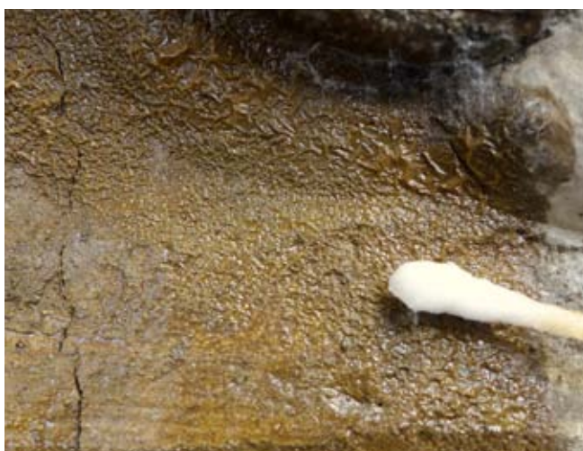
FIG. 318 Test n° 2 : acétone 80% + White Spirit 20%. Ramollissement et clochage du vernis et de la patine brunâtre.
