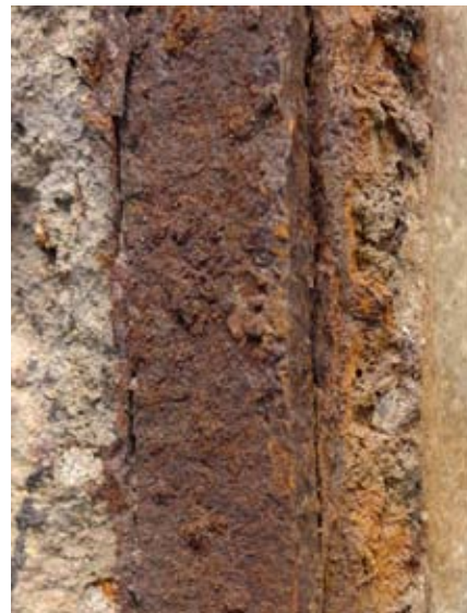
FIG. 251 Surface piquetée et recouverte de produits de corrosion pulvérulents.
